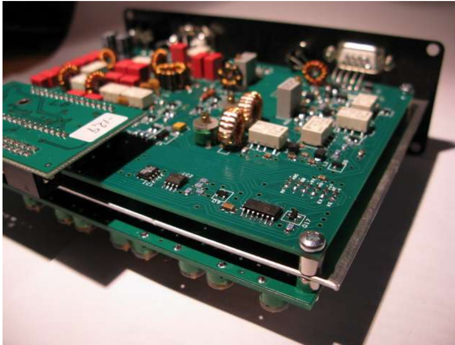
Bilden visar monterat B-kort. C (Control)-kortet sitter som synes monterat på B-kortet. Detta kan fixeras med skruv och distanser (syns ej i bild) till C-kortet.
