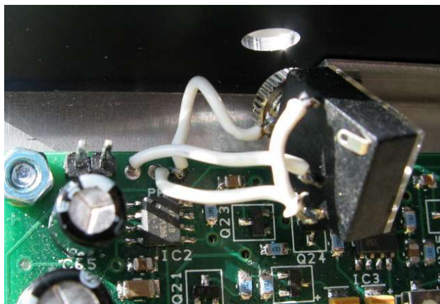
Kontakt för extern högtalare/headset. Mittledare och ring kopplas samman.
