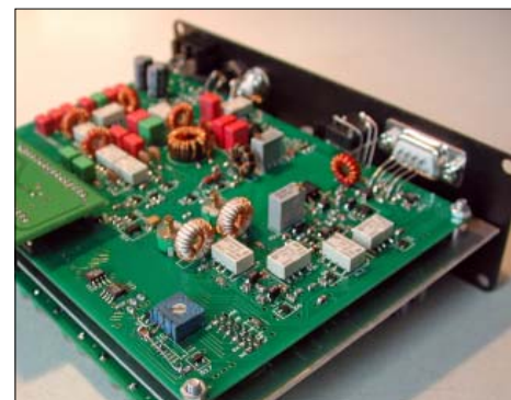
Fig 4, B-kortet. Detta kort innehåller sändarkedjan med sina lågpasfilter.
